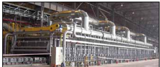
Rollenherdofen für Grobblech mit RECUFIRE®-Strahlheizrohren RECUFIRE® radiant tubes on a roller hearth furnace for plate
